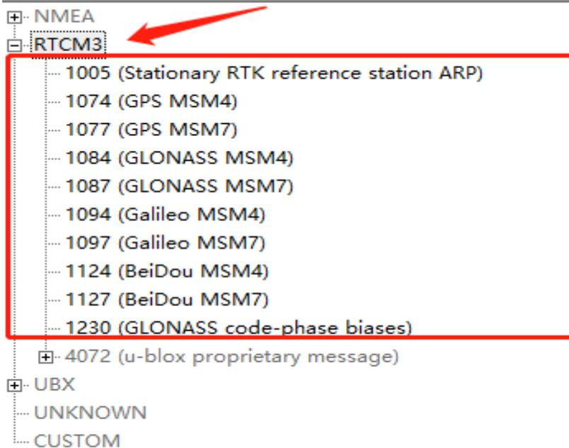
备注：打开RTCM3,下拉框，如果选项中灰度都显示正常，表示已经正常获取到RTCM数据。
