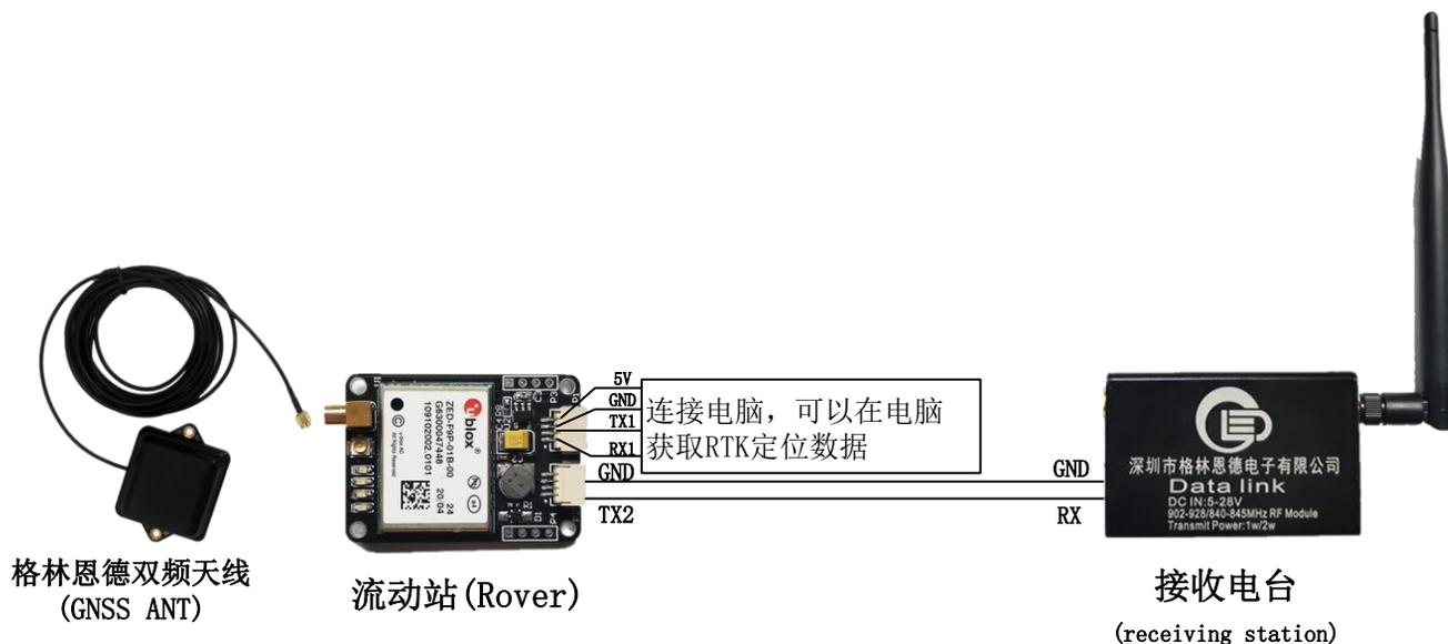
格林恩德GLED-F9P-RTK模块, 分别配置成基准站、流动站, 配合格林恩德电台使用, 用户通过流动站的串口1即可获取到高精度定位信息。
