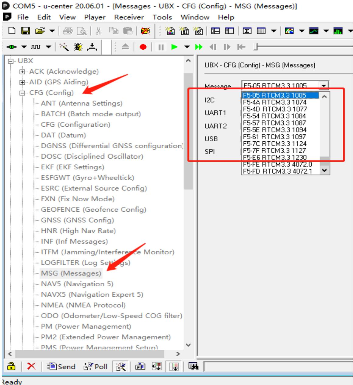
注意：在UBX-CFG 下选择MSG ,在message选项中，需要**逐条发送RTCM3.3\_1005—RTCM3.3\_1230** RTCM协议的原始数据。下面以发送RTCM3.3\_1005为例：
